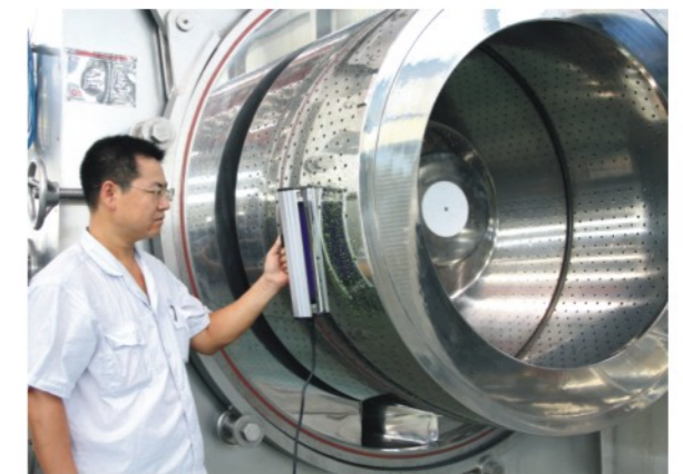
在线清洗核黄素检测 Viboflavin test for CIP effect
